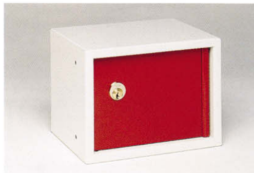
SONO SFS 004, vor allermindeste opbevaringsboks, leveres i separate enheder til vægmontering. Denne boksmodel har en 3 mm tyk ståldør og kan forsynes med cylinderlås, hængelåsbeslag samt møntlås med returrende.
